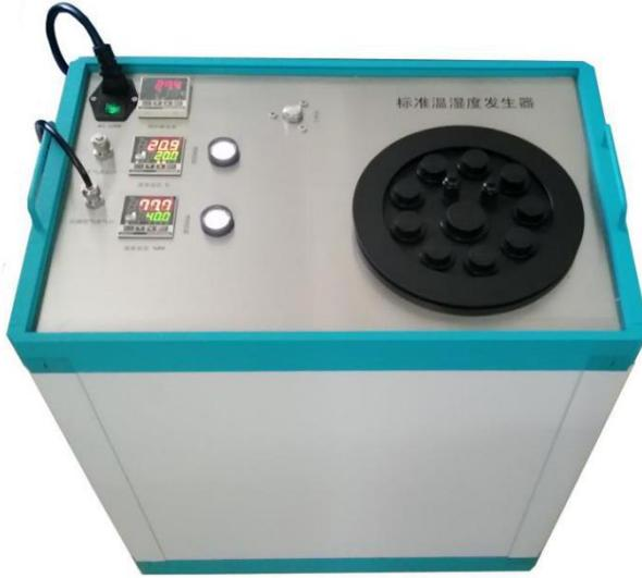
THG-100 是一款高精度、高可靠性温湿度发生器，采用干湿气流混合法湿度发生工作原理。测量腔体内部安装了高精度温湿度传感器，用于测量并控制发生器腔体内的温度和湿度，并在工作范围内任意连续可调。
