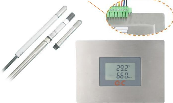
生物制药行业的洁净室、实验室需要对环境温湿度进行严格控制，同时要求现场安装仪表的结构防尘防积灰，TH120-E 采用防尘防积灰的嵌墙式安装结构，信号线缆通过背部接线端子接入，方便设备维护，适用于生物制药 EMS 系统温湿度监测。
